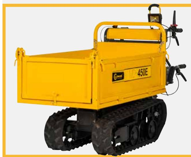
Motorleistung 800 W, Nennspannung 60 V
