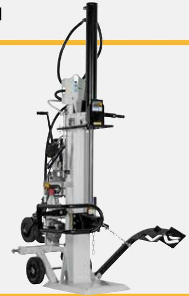
**Elektromotor** 4,5 kW, 400 V und Zapfwellengetriebe mit Dreipunktaufhängung Kat.I + Kat. II
