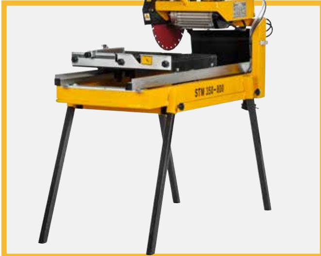
230 V, 2,2 kW S6 40% bei 2.800 U/min
